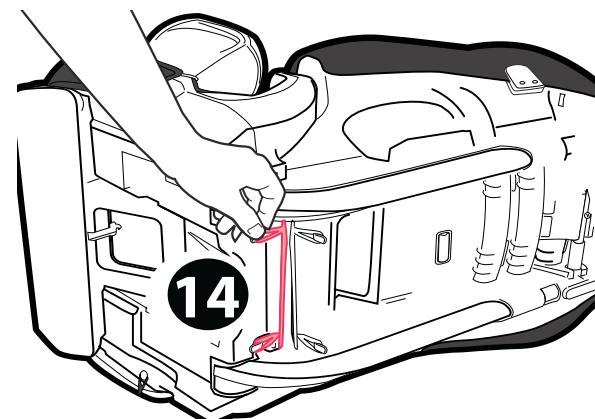
14. ⑮のように、シートカバー上のゴムループをラップベルト用ガイドに通して引っ張りフックにかけます。反対側も同様にします。
