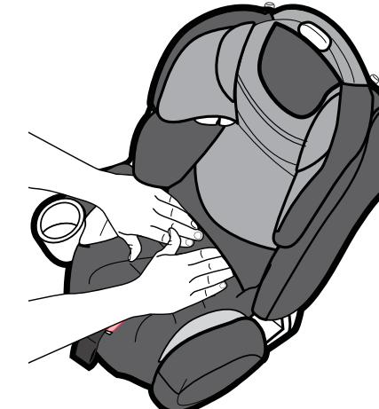
13. ⑭のように、2ヶ所のシートカバーのゴムループをチャイルドシートの座面後部にあるフックにかけます。
