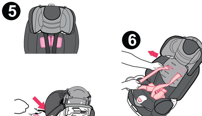
6. シート前部のハーネス調節ベルト⑧を引き、ジョイント金具を固定します。
