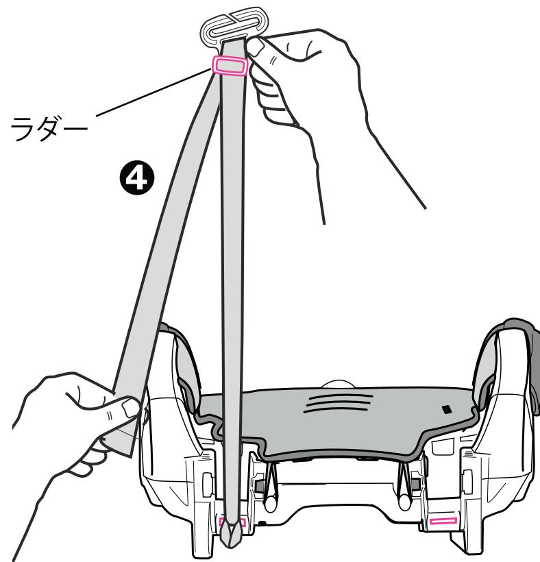
4. ⑤のように、車のショルダーベルトをクリップに通します。クリップの根元にあるラダーをゆるめてストラップの長さを調節し、お子様の肩に合わせます⑥。
