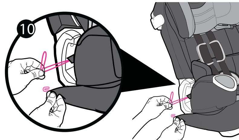
9. シートカバーを引き出して、シート部分にある赤のロックボタンを出します⑪。ボタンをバックサポート側にスライドさせて本体を後方に倒します。このときバックサポートが落下したり、何かに当たったりしないよう注意してください。後方に倒す際、手や指、その他をバックサポートの後側に置かないようにします。
