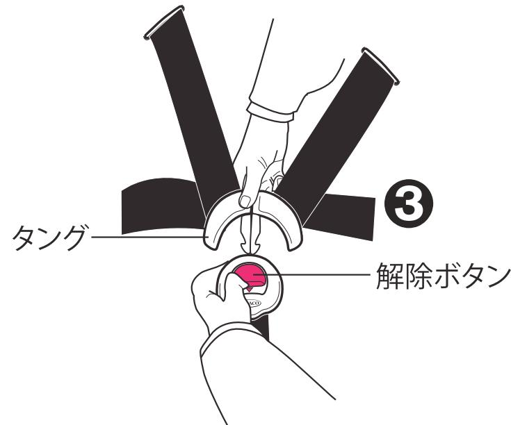
**3. クロッチストラップの確認:**お子様の体格にあわせてクロッチストラップの位置を2段階に変更できます。お子様の下にならず、なるべくお子様の間に隙間がない位置を選びます。
