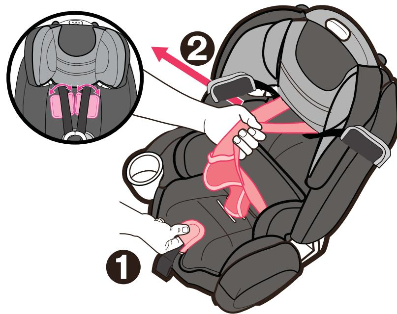
2. ハーネスバックルの解除ボタンを強く押し下げ、タング③を外します。
