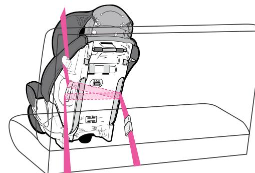
4. シートベルトをチャイルドシートの側面にあるロックオフデバイスのリリースボタンを押し下げながら差し込みます③。
