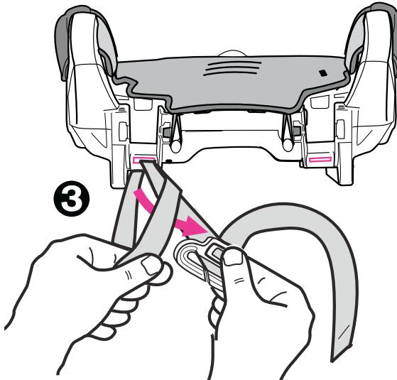
3. **注記**: クリップの根元にあるラダーをゆるめてストラップの長さを調節します。ストラップのあまりは④のようにシートの前側にくるようにしてください。
