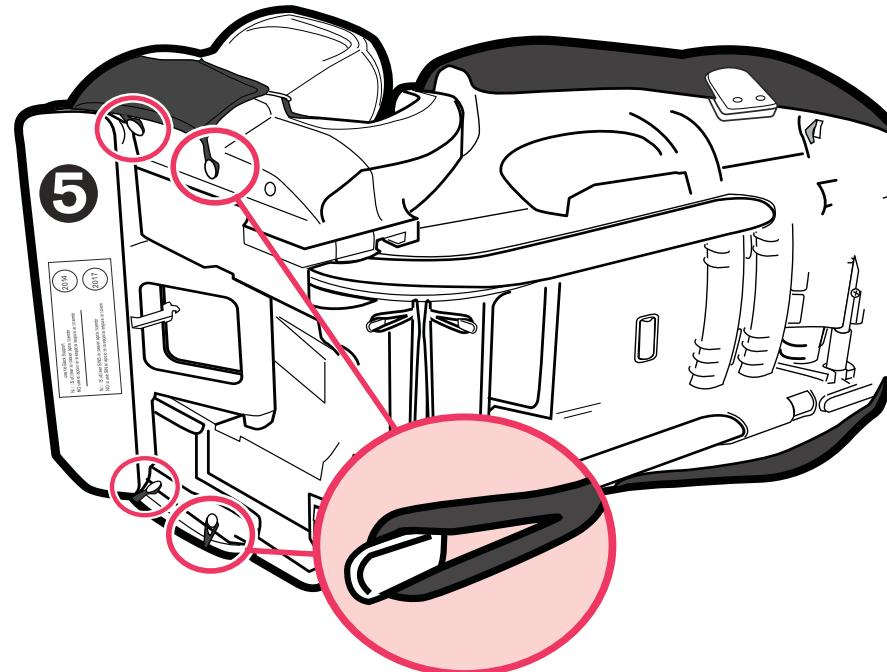
5. ⑥のように、シートカバー上のゴムループをラップベルト用ガイドに通して引っ張り戻す。反対側も同様にします。
