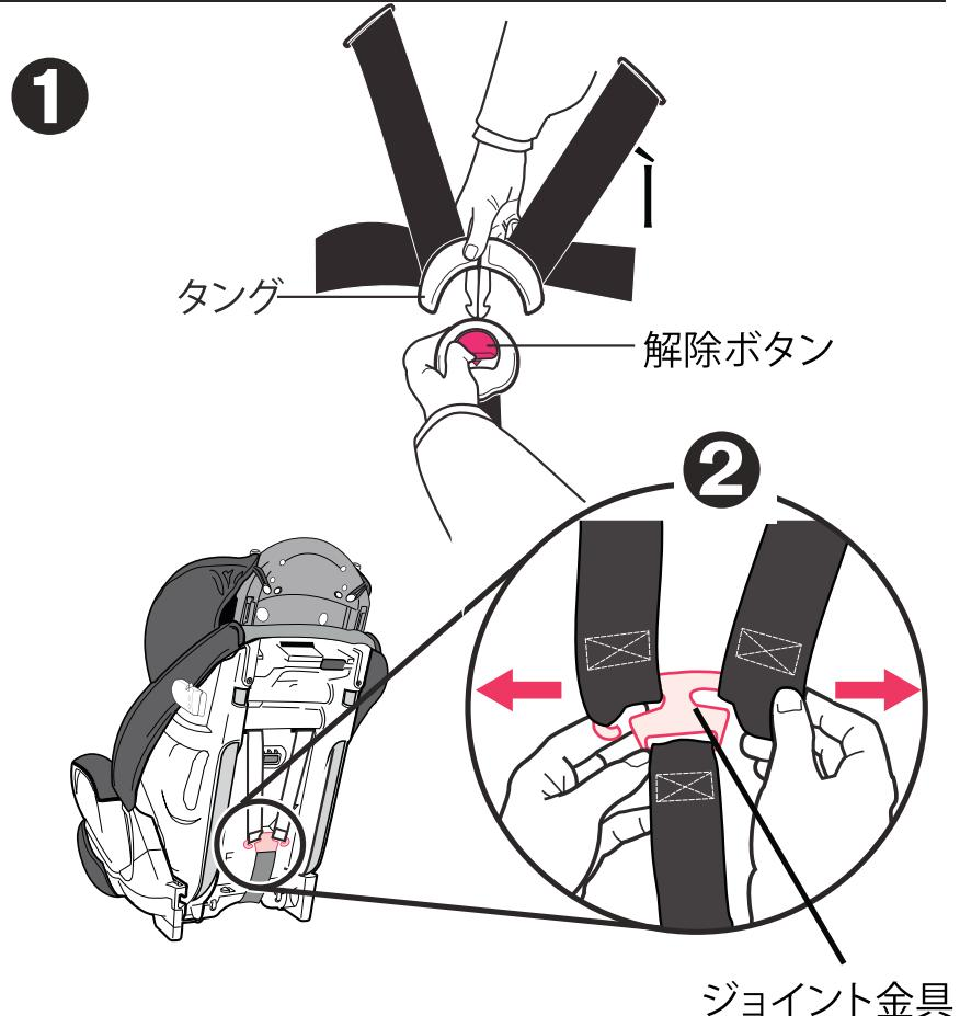
2. シートを後側に向け、ジョイント金具からストラップを取り外します②。
