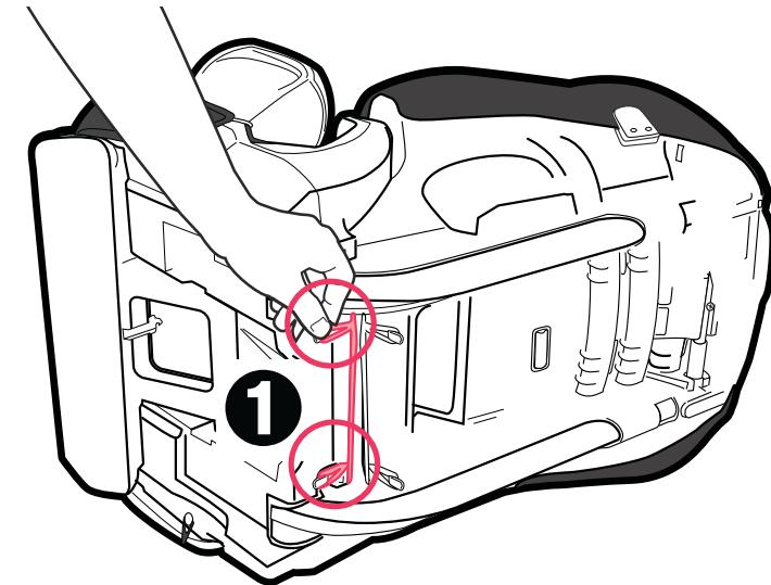
2. ② のようにシート両側の車のシートベルト用ガイドに通したゴムループを外します。反対側も同様にします。
