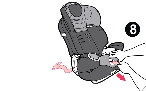
7. シートの後側を向け、⑨のようにフックからシートパッド下部の2ヶ所のゴムループを外します。
